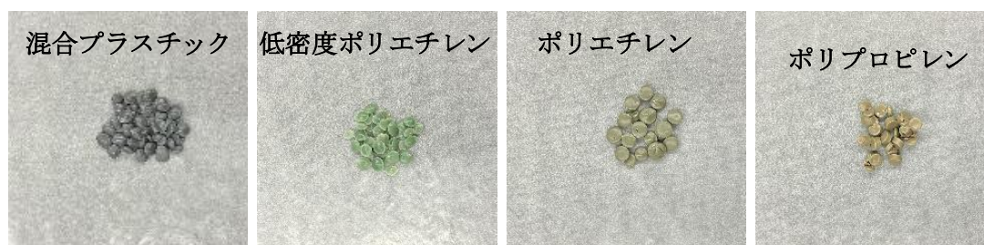
図 3-2 再生プラスチックペレット試料の一例
