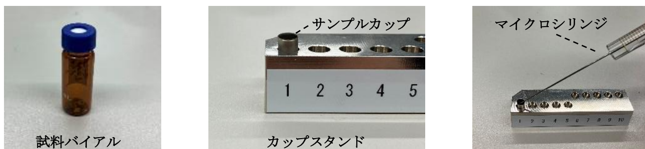
図 3-10 試料調製に用いた器具
