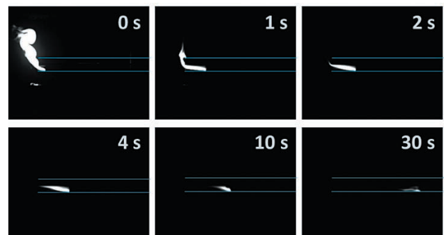
図3. 水素供給停止時に管内にむけて伝播する火炎の連続写真
